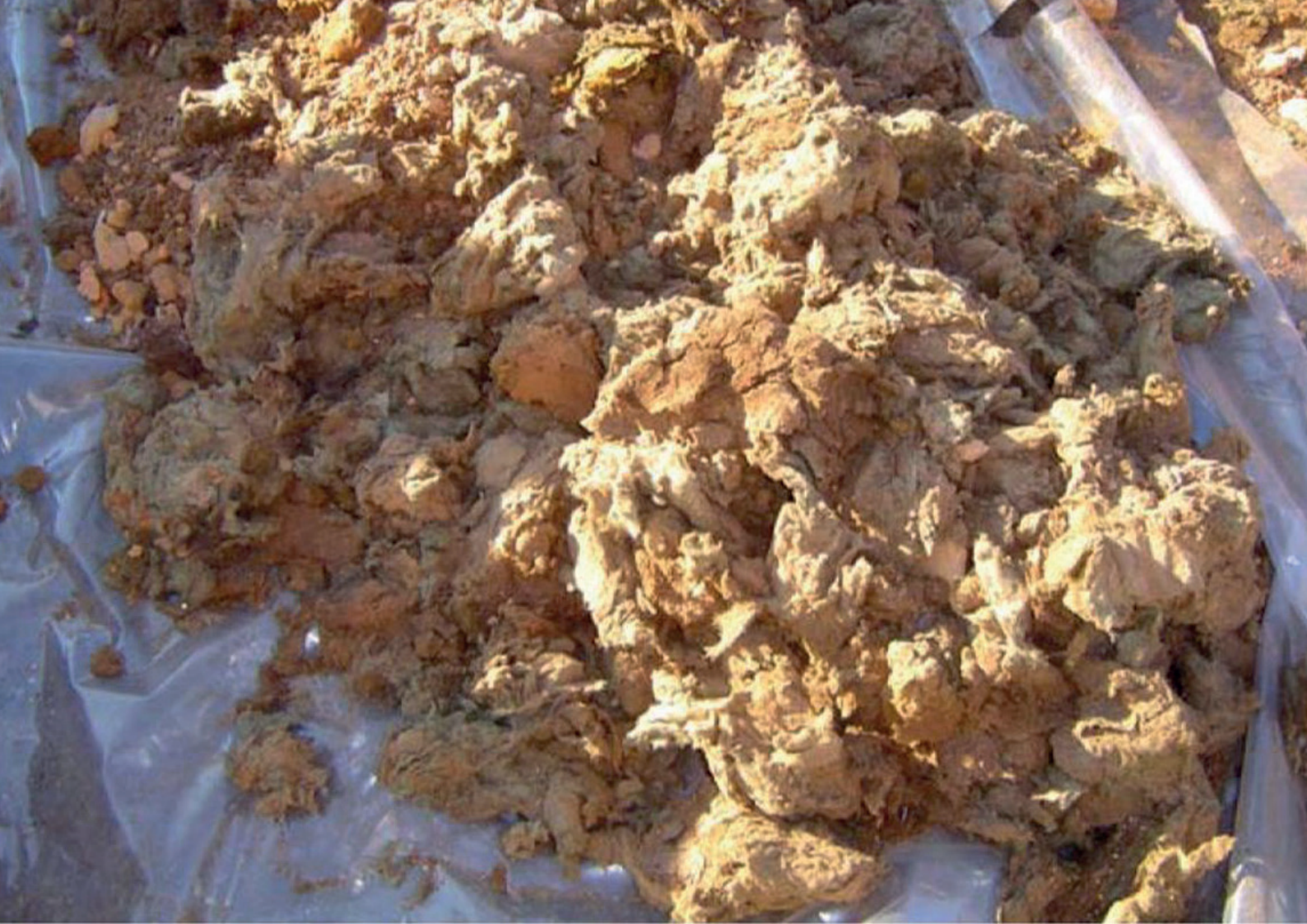
Radioactief slakkenwol zoals aangetroffen in een lading ferrometaal bij een metaal recyclingbedrijf
